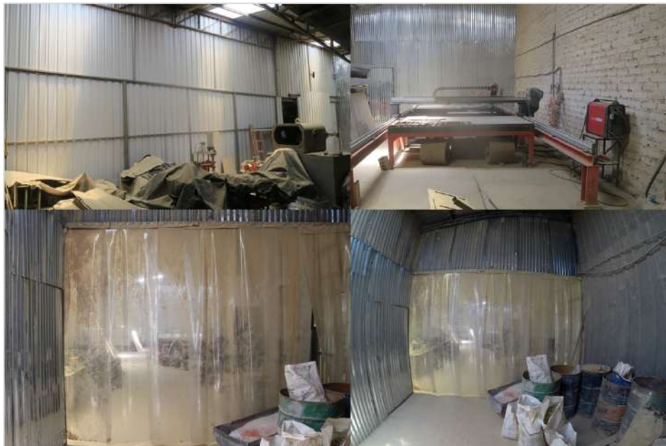
Anexo 45. Áreas con cubiertas para evitar la expansión de polvo/material particulado
